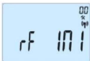
Der Thermostat sendet ein Funk-Konfigurationssignal zum Empfänger.
