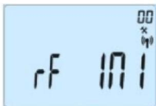
Mittels der Tasten (<) oder (>) den Parameter auswählen, der zu ändern ist. Den Wert mit der Taste (OK) bezeichnen, ihn mittels der Tasten (-) oder (+) ändern und die Änderung mit Betätigung der Taste (OK) bestätigen.
