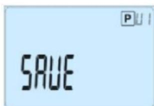
Um das Programm zu speichern, die Taste (OK) betätigen. Es erfolgt Rückkehr in den Betriebsmodus **AUTO**; der Thermostat arbeitet nach dem eingestellten Programm.
