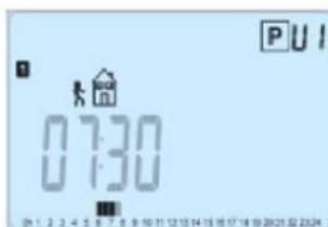
Mittels der Tasten (-) oder (+) die Uhr der Rückkehr einstellen.
