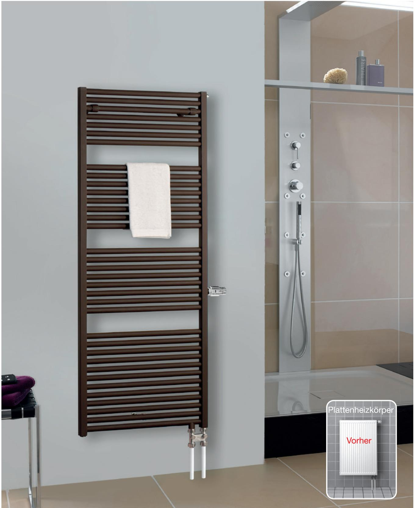
BEMM Rondo V 1482 x 602 mm im Farbton Dunkelbraun (Nr. BR) mit Sonderanschluss, serienmäßig mit Einbauventil und Thermostat Puro in Chrom. Für den Austausch gegen einen alten Ventilheizkörper wird zusätzlich ein Hahnblock-Umlenkstück benötigt, da der Vorlauf beim Rondo V immer außen ist, beim Ventilplattenheizkörper jedoch innen ist.
